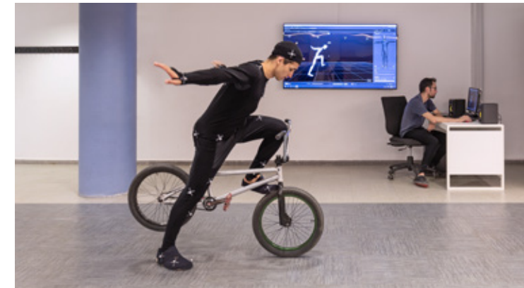
Motion Capture Sala configurada para la captura y procesado de movimiento con 12 cámaras especiales Optitrack Prime 13, dos uniformes Motion Capture Suit equipados con sensores y una pantalla de 75" para ver los resultados a tiempo real.
